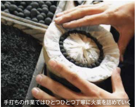
手打ちの作業ではひとつひとつ丁寧に火薬を詰めていく
