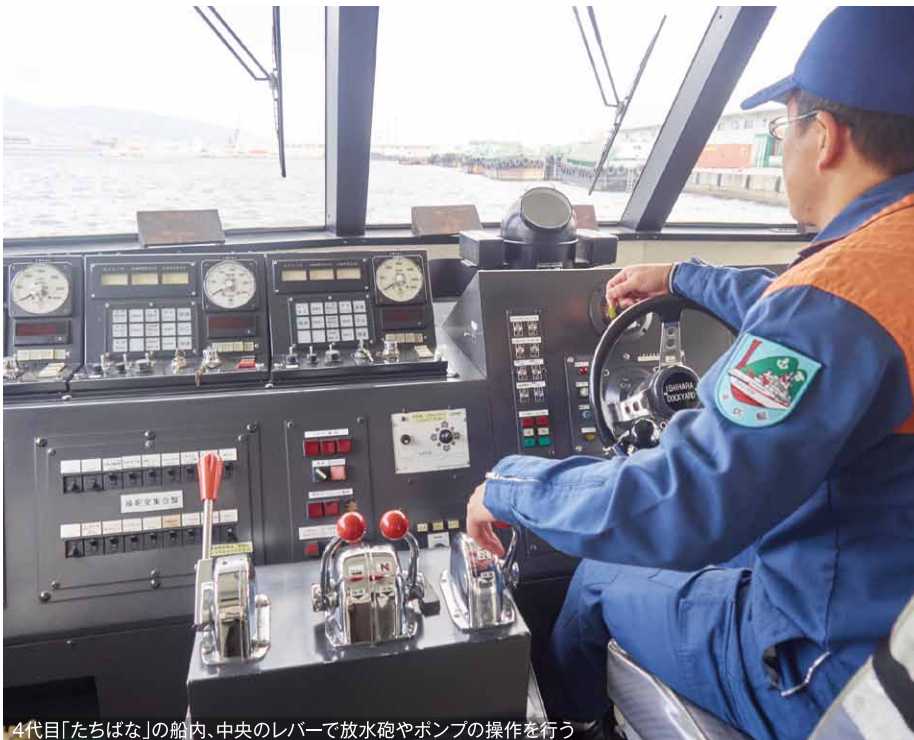
4代目「たちばな」の船内、中央のレバーで放水砲やポンプの操作を行う
